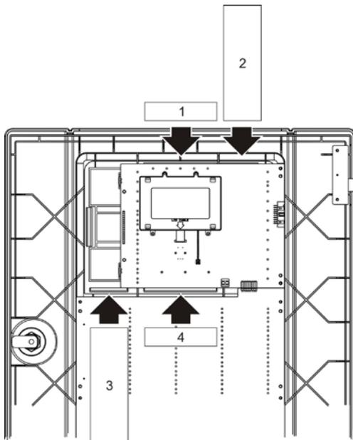
Cada parte insertable está numerada como 1, 2, 3 y 4, y se inserta en la ubicación indicada (con la zona impresa mirando hacia la parte delantera de la central).
