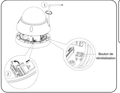
Remarque : Pour réinitialiser la caméra (c.-à-d. rétablir ses paramètres par défaut), appuyez sur le bouton de réinitialisation pendant 8 secondes ; le voyant s'éteint.
