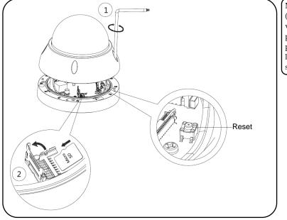
Nota: Per il reset (usato per tornare ai valori di fabbrica), premere il tasto Reset per 8 secondi; l'indicatore luminoso si spegnerà.
