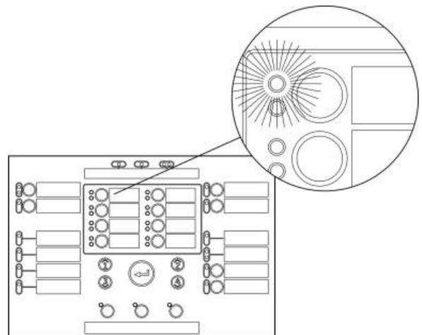
Si los LED de alarma de incendio y de alarma de zona parpadean, significa que la alarma de incendio se ha activado mediante un detector. Si permanecen fijos es que se ha activado mediante un pulsador.
