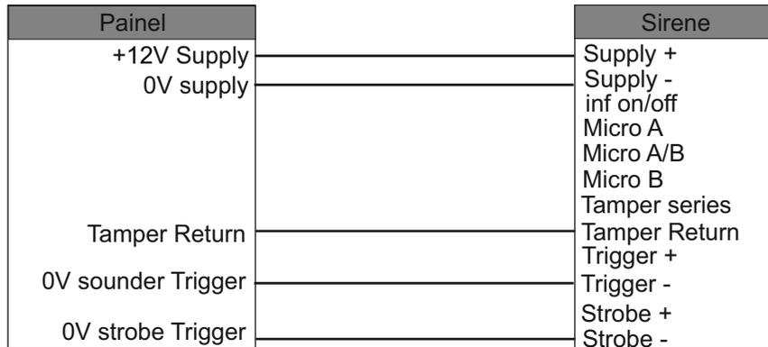
Esquema de conexiones para un 5-cables, con dos sirenas en serie.(Trigger negativo)
