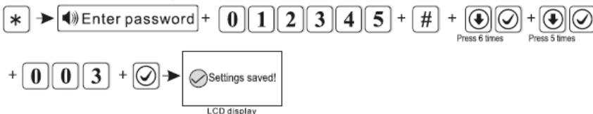
El intervalo de tiempo de la prueba de comunicación se puede configurar desde 0-999, marcar 0 si es inferior a 3 bits. Una vez que se han completado los ajustes, la pantalla volverá, automáticamente, a la interfaz superior.
