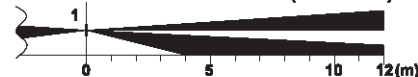
[ POSITION B ] Zone de détection vue de côté: 8 m (un seul côté)
