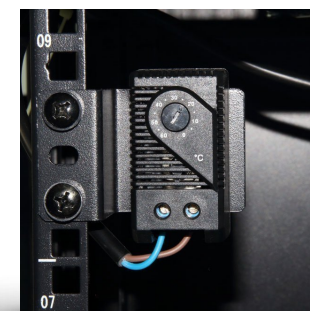
Termostato de regulación y control de los ventiladores incorporados en la serie HQ de racks.
