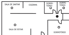
Figura 1: Locais para o estabelecimento de detectores de fumo e de calor numa residência com um dormitório
