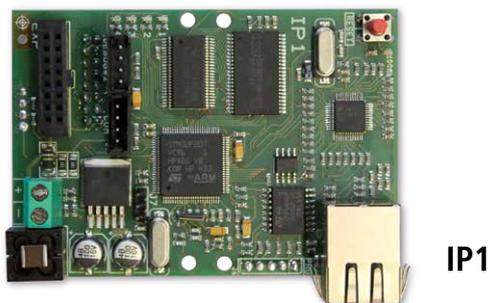
**La manipulación del módulo LAN debe realizarse siempre con la placa de alarma totalmente sin alimentación!**
