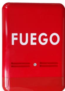
La sirena de alarma de incendio ha sido diseñada para uso en el exterior de edificios, con el fin de avisar al personal externo de la detección de un inicio de incendio por el sistema de detección y alarma de incendio de dicho edificio. Con este fin, combina una señal acústica y una indicación luminosa intermitente. Para su activación sólo se requiere suministrar la tensión correspondiente.
